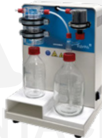
UNIDAD DE NEUTRALIZACIÓN DE GASES
